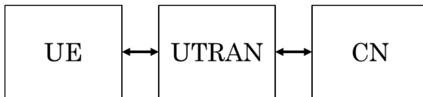
Figura 5 – Componentes básicos de uma rede celular
